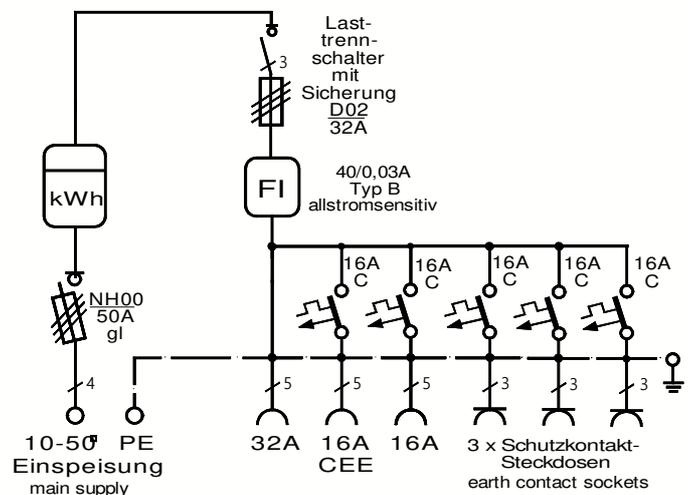
**ELEKTRA** - Anschlussverteilerschrank im Gehäuse aus verzinktem Stahlblech, pulverbeschichtet RAL 6018, bestückt mit:
