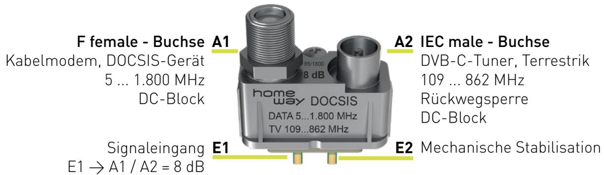
**Rückwegtaugliches DOCSIS Kabel-TV-Modul** zur Verwendung in allen homeway Basisdosen (classic, TiwGa, one., one.fiber). Für die Entnahme von CATV und den Anschluss eines interaktiven DOCSIS-Gerätes (z.B. Kabelmodem, Router).
