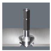
3-nutiger Kegelsenker-Bit, 90° • Einsatz: Zum Entgraten, Fasen, Senken • 1/4"-Antrieb passend für Halter nach DIN 3126-D 6,3 (ISO 1173) • Sehr gute Kraftübertragung durch Sechskant-Schaft HSS Hochleistungsschnell-Stahl • Fein abgestimmte Material- Elastizität hohe Standzeiten • 3 Schneiden Sehr Zentriereigenschaften Problemloses Schneiden Einwandfreie Spanabfuhr Geringe Verkantungsgefahr Präzise Rücklaufführung • Hoher Korrosionsschutz
