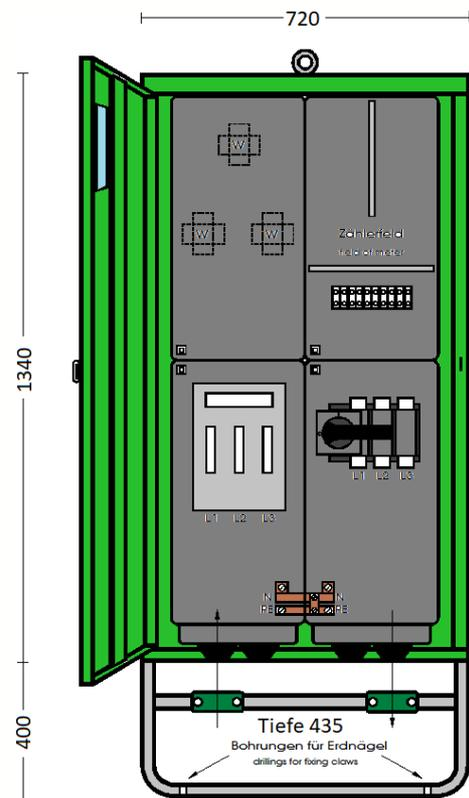
**ELEKTRA** - Anschlusschrank im Gehäuse aus verzinktem Stahlblech, pulverbeschichtet RAL 6018, bestückt mit:
