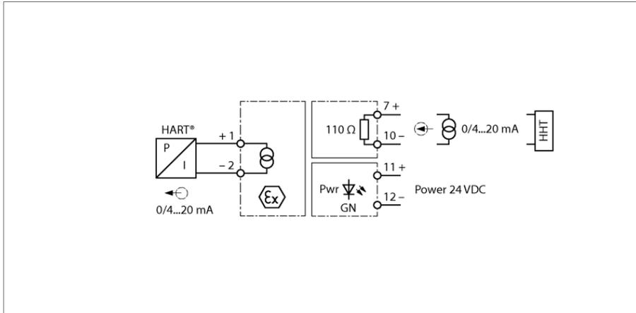
Über den 1-kanaligen Signaltrenner IM35-11EX-HI/24VDC wird das normierte Stromsignal galvanisch getrennt aus dem Nicht-Ex-Bereich in den Ex-Bereich ohne Beeinflussung 1:1 übertragen. Neben dem Analogsignal können bidirektional auch die digitalen Signale der HART®-Kommunikation übertragen werden.
