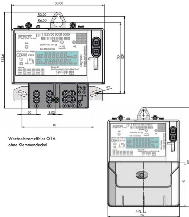
Wechselstromzähler Q1A ohne Klemmendeckel
