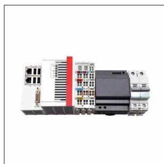
SITECO Connect 11Grundpaket M/D, 1..40 DALI-Linien, Hutschienen PC, zentrale Steuerung - Anbindung an Licht- oder Gebäudemanagement, Montageart: Einbau, Montageort: in einer elektr. Verteilung, Schutzart (gesamt): IP20, Schutzklasse (gesamt): SK I (Schutzerdung), Prüfzeichen: CE, Spannung: 230V, Spannungsart: AC, 1 x DALI-2, Software: Lighting Solution, Verpackungseinheit: 1 Stück
