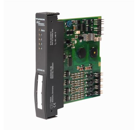
Das Ausgangsmodul AOH40-N dient zum Anschluss von analogen Aktuatoren wie Stellventilen oder Prozessanzeigen.
