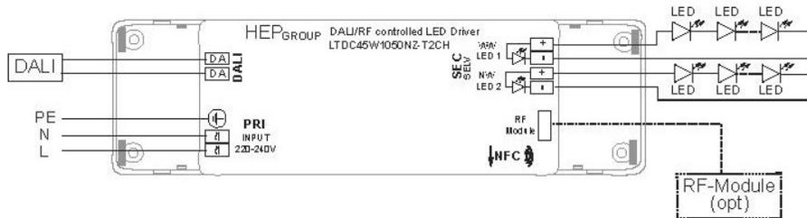
Leiterquerschnittsfläche für Eingangsklemme: 0,75-1,5 mm<sup>2</sup> (Kabeltype mindestens H03VVH2-F)
