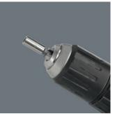
Universalhalter für die Aufnahme Bits 1/4"-Außensechskantantrieb. Edelstahlhülse für besonderen Korrosionsschutz. Der Sprengring garantiert optimalen Sitz des Werkzeugs im Halter. Der starke Dauermagnet hält die Bits bombenfest. Passend für Schraubermaschinen mit Aufnahme nach DIN ISO 1173-F 6,3.
