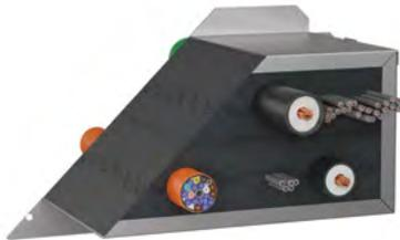
Die Akustikbox E ist anders als die Standardbox mit Waffelschaumstoff voll belegt. Das Blechgehäuse kann mit einem Spannverschluss bequem geöffnet werden. Die Schaumstofflagen in der Box können dann herausgenommen werden. Die Lagen bestehen aus eins zu eins ineinandergreifenden Noppenschaumstoffen. Der Schaumstoff kann zugeschnitten und z.B. an verlegte Kabeltrassen angepasst werden.
