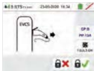
Verriegelungstest im Prüfablauf EVSE
