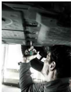
Der Quergriff 411 A RA ist für 1/4" Steckschlüsselleinsätze geeignet. Die Steckschlüsse werden durch die Kugel sicher verriegelt.
