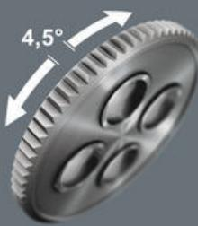
Die integrierte Ratsche mit Feinverzahnung (80 Zähne) und einem Rückholwinkel von 4,5° vereinfacht und beschleunigt das Schrauben ohne mühsames Neuansetzen.
