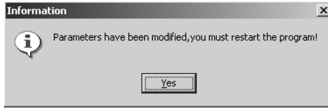
Bild 2-18 Nach den Funktionen „Add“, „Modify“ und „Delete“ muss das Programm neu gestartet werden
