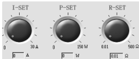
Bild 2-7 Einstellendrehknopf für Strom, Leistung und Widerstand
