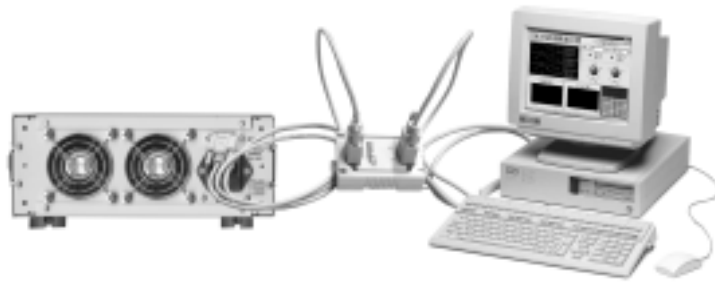
Bild 1-1 Schließen Sie die elektronische Last an den PC an
