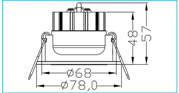
Die Deckeneinbauleuchte COB 68 RGBW verfügt über einen eigens entwickelten RGBW-Chip [RGB + Warmweiß], der in Kombination mit dem integrierten Reflektor eine homogene Farbmischung gewährleistet und verschiedene Lichtstimmungen über diverse Lichtsteuerungsoptionen ermöglicht. Damit eignet sich die Innenleuchte sowohl für den Einsatz in Wohnräumen als auch in Bars, Clubs sowie weiteren Umgebungen, die auf eine flexible Beleuchtung Wert legen.
