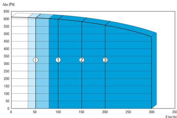
Die abgebildeten Zahlen zeigen die voreingestellten Lüftungsstufen ("Werkseinstellungen").
