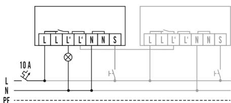
Standardbetrieb mit optionaler Ansteuerung durch Schließtaster und Parallelschaltung von max. 8 Geräten
