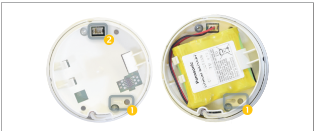
Abb. 9: Rückseite Funkrauchschalter (ORS 155F) ohne und mit Batteriepack BPF 155. Eingabetaste ❶ mit Pfeil gekennzeichnet sowie Anschluss für Batteriepack BPF 155 ❷.
