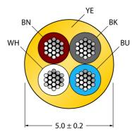
Leitungsdurchmesser 5 ± 0.20mm Leitungslänge 2 m Leitungsmaterial PVC Gelb Leitungsfarbe Aderisolierung PVC Aderfarben
