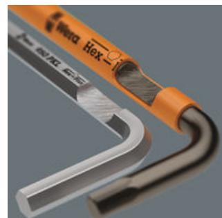
Wir haben die klassischen Winkelschlüssel einfach in Frage gestellt, weil sie beim Arbeiten viel zu oft die Schraubenkopfprofile verrunden. Mit der Folge, dass Schrauben nicht mehr betätigt werden können und man abrutscht. Wera Hex-Plus Werkzeuge haben größere Anlageflächen im Schraubenkopf. Die Kerbwirkung und damit die Deformierung der Schraube werden verringert. Gleichzeitig können bis zu 20 % höhere Drehmomente übertragen werden.
