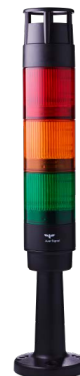
Artikel-Nr.: CT5-Q31 Farben: rot-orange-grün Funktion: LED Dauerlicht, Piezo Summermodul 1 von 8 Tönen via DIP-Schalter auswählbar Nennspannung: 24 V DC Montageart: Rohrmontage (100 mm Rohrlänge)
