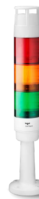
Artikel-Nr.: CT5-Q06 Farben: rot-orange-grün Funktion: LED Dauerlicht, Piezo Summermodul 1 von 8 Tönen via DIP-Schalter auswählbar Nennspannung: 24 V DC Montageart: Rohrmontage (100 mm Rohrlänge)
