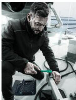
Die Zyklop Comfort Knarre ermöglicht durch ihre Feinverzahnung mit 80 Zähnen einen kurzen Rückholwinkel von nur 4,5°.
