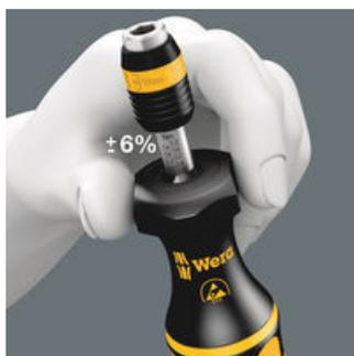
Messgenauigkeit  $\pm 6\%$  (Artikel 1430:  $\pm 10\%$ ) nach Norm DIN EN ISO 6789. Deutlich hör- und spürbares Überrasten beim Erreichen des eingestellten Drehmoments.
