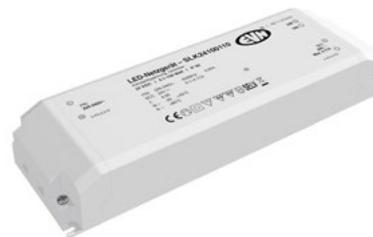
Der kurzschlussfeste Sicherheitstransformator darf ausschließlich im Innenbereich verwendet werden, kann aber z. B. auch beim Möbelbau verwendet werden, da die MM-Kennzeichnung gegeben ist. Zusätzlich lässt sich das Netzgerät primärseitig dimmen. Die Schraubklemmen primär-, und sekundärseitig sind für Kabel von 0,75-2,5mm<sup>2</sup> geeignet. Technische Daten: Versorgungsspannung: 220-240V/AC, ta: -20°C - 45°C, tc: 85°C, Powerfaktor 0,95.
