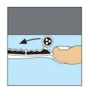
Große Griffteile an den Enden der Bügel erleichtern das Einlegen und Nachverlegen von Leitungen.
