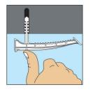
Schnelles Befestigen in abgehängten Decken.
