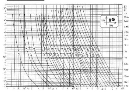
Die mittleren Zeit-Strom-Kennlinien gelten bei einer Umgebungstemperatur von 20 + 5°C und den in den Vorschriften für den Prüfbau zugeordneten Kabel-(Leitungs-)Querschnitten.
