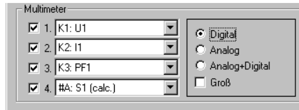
Abb. 3.5.4-a: Festlegen der Art der Multimeter-anzeige und der darzustellenden Kanäle im Dialogfenster Einstellung Kanalansichten
