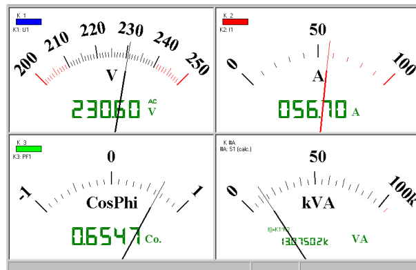
Abb. 3.5.4-d: Darstellung von vier Kanälen in der Ansicht Multimeter Analog+Digital K1: manuell skaliert (gedehnt) mit Min.- und Max.-Grenzwerten K2: manuell skaliert mit Max.-Grenzwert K3: manuell skaliert, Nullpunkt mittig K4 (berechneter Kanal): automatisch skaliert
