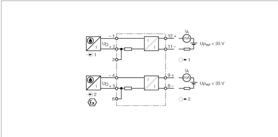
Der 1-kanalige Messumformer-Speisetrenner für Brand- und Rauchmelder IM33-FSD-EX/L ist speziell für den Anschluss von konventionellen Brand- und Rauchmeldern im Ex-Bereich konzipiert.
