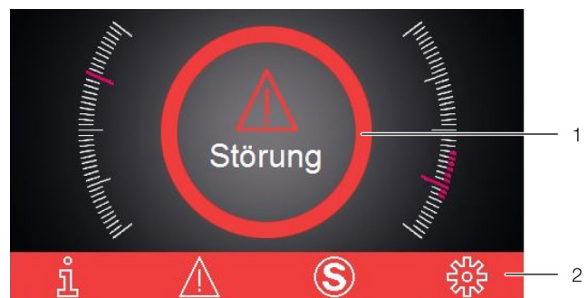
Abb. 24: Bildschirm bei Auftreten einer Störung
