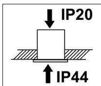
**DE** Voraussetzung für die Schutzart IP 44 der Leuchte ist die Installation in einer geschlossenen Decke! Die Schutzart IP 44 gilt nur von der Raumseite her.
