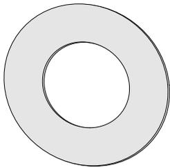
**DE** Bei dünnem oder weichem Deckenmaterial empfiehlt sich die Verwendung des Deckenverstärkungsringes zur Vergrößerung der Auflagefläche!
