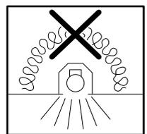
**DE** Leuchte darf nicht mit Wärmedämmung abgedeckt werden.
