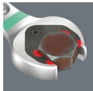
Die clevere Doppelsechskant-Geometrie des Jokers macht die Verbindung mit Schraube oder Mutter formschlüssig - das sitzt. Und die auswechselbare, gehärtete Metallplatte im Maul des Jokers verbeißt sich mit extrem harten Spitzen in die Schraube. Beides verringert die Abrutschgefahr auch bei hohen Drehmomenten.
