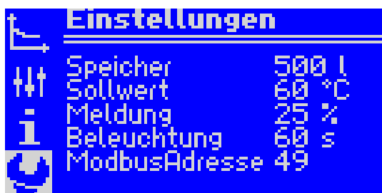
Abb. 5.7: Anzeige Einstellungs Menü (1. Ebene)
