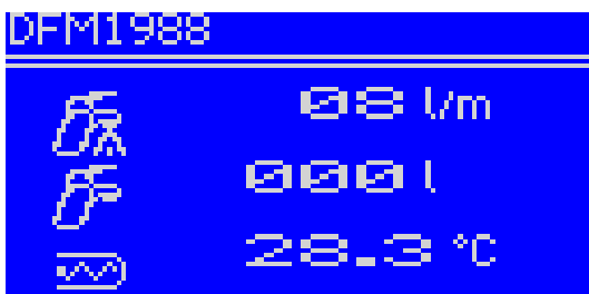
Abb. 5.3: Bereitschaftsanzeige mit momentaner Wasserentnahme
