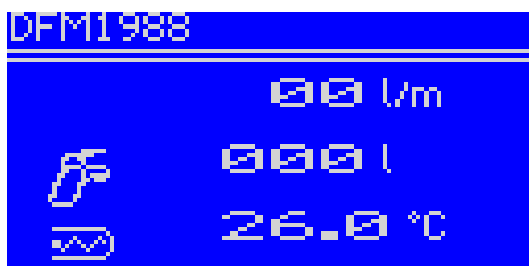
Abb. 5.2: Bereitschaftsanzeige ohne momentane Wasserentnahme
