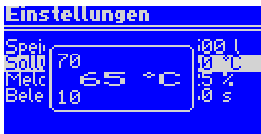
Abb. 5.11: Beispiel - Änderung des Sollwertes von 60 °C auf 65 °C
