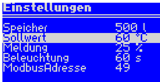
Abb. 5.10: Beispiel - Änderung des Sollwertes von 60 °C auf 65 °C
