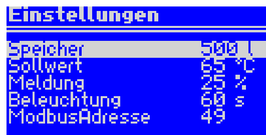
Abb. 5.12: Beispiel - Änderung des Sollwertes von 60 °C auf 65 °C
