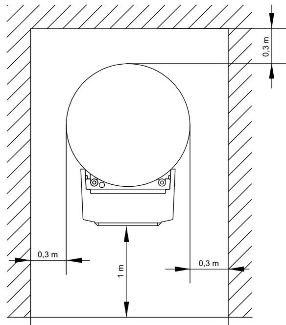
Bei Installation des Hydraulik-Towers in einem Obergeschoss ist die Tragfähigkeit der Decke zu prüfen und aus akustischen Gründen die Schwingungsentkoppelung sehr sorgfältig zu planen. Eine Aufstellung auf einer Holzdecke ist abzulehnen.
