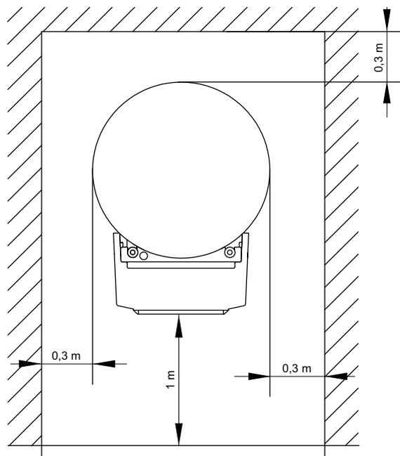
Si la tour hydraulique combinée est installée à l'étage, il faut contrôler la résistance au poids du plafond et le découplage vibratoire pour des raisons acoustiques. Une installation sur un plancher en bois ne peut être acceptée.
