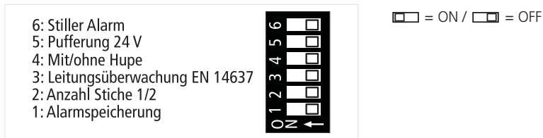
Abb. 5: DIP-Schalter für Konfiguration der FSZ Pro
