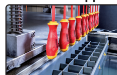
Stückgeprüft mit 10.000 Volt
