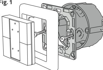
► Fig. 1 Den Taster entsprechend der Zeichnung montieren.
