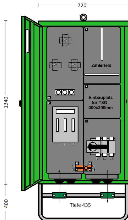
**ELEKTRA** - Anschlusssschrank im Gehäuse aus verzinktem Stahlblech, pulverbeschichtet RAL 6018, bestückt mit:
