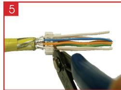
5 Adern mit einem wasserfreien Seitenschneider bündig kürzen.
