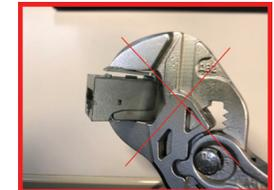
Setzen Sie die Presszange nie auf der Rastnase an. Diese verbiegt sich dadurch.
