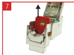
7 Transportsicherung entfernen. Transportsicherung besteht aus kompostierbaren Bio-Kunststoff.
