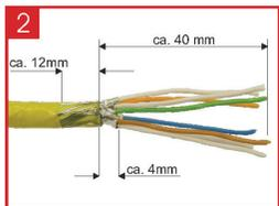
2 Schirmgeflecht über den Kabelmante zurückziehen und mit Klebeband fixieren. Folienschirm auf 4mm kürzen.
