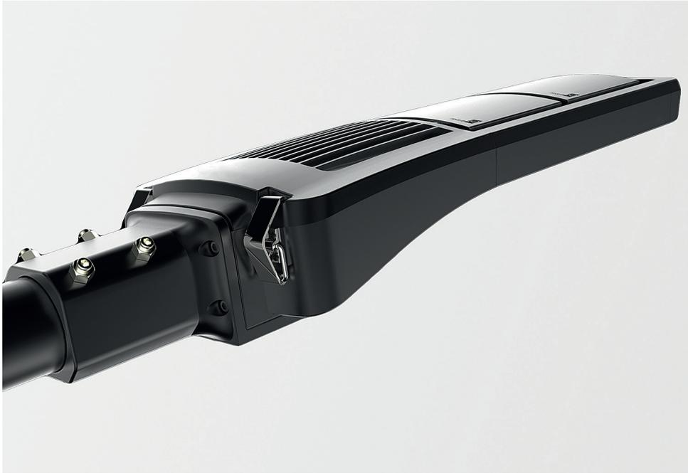
Modulare LED Straßenleuchte mit besonders effizienter Lichtverteilung, Aluminiumgehäuse, für Mast-Aufsatz und Mast-Ansatz-Montage bei Mast-Durchmesser Ø 60 mm (Zopfmaß), Mastadapter für Zopfmaß Ø 48 mm und Ø 78 mm sind optional erhältlich, auswechselbare LED Module mit je max. 60 Watt (*plug & play*), austauschbare Elektronik-Komponenten in IP 65 Gehäuse:
