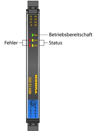
Der 2-kanalige Ventil-Steuerbaustein vom Typ IMX12-DO01-2U-2U-0/24VDC/CC stellt ein in Strom und Spannung begrenztes, eigensicheres Ausgangssignal bereit. Somit können Verbraucher im explosionsgefährdeten Bereich direkt angesprochen werden. Typische Anwendungen sind das Ansteuern von Ex i-Pilotventilen, das Versorgen von Anzeigen und die Versorgung von Transmittern.
