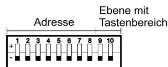
In Werkseinstellung bildet der FS3H2 die Tasten 1-4 der Ebene A nach (bezogen auf die Schalk Sender mit 8 Sendetasten)
