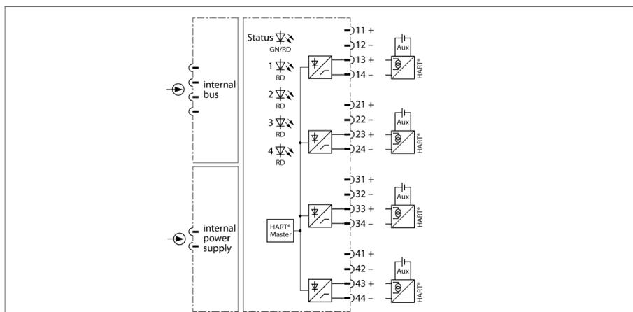
Das Eingangsmodul AIH41Ex dient zum Anschluss von 4-Leiter-Messumformern (passiver Eingang = nicht speisend / Geber aktiv).
