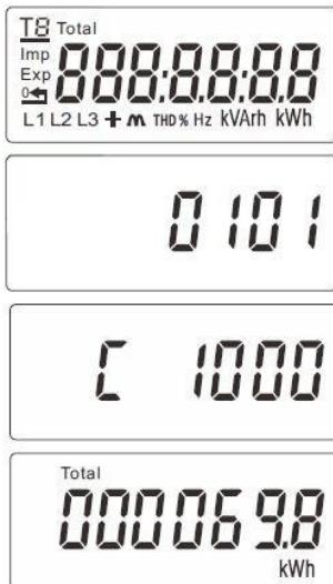
Die Standardanzeige ist die Gesamtwirkleistung kWh für PDSZDMID 100 während des Imports von Wirkenergie für PDSZDMID 100
