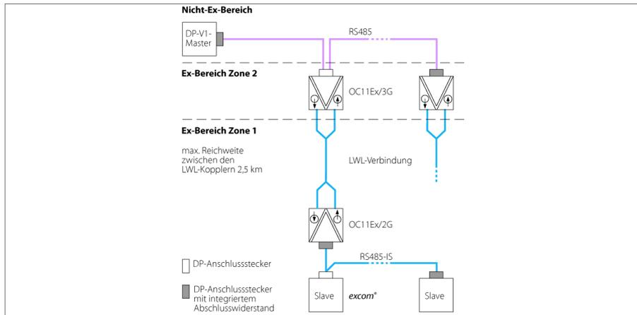
Der LWL-Koppler OC11Ex/2G.2 wandelt die PROFIBUS-DP-Signale von Kupferleitungen auf Lichtwellenleiter um. So lassen sich die Bussignale aus dem sicheren Bereich in den Ex-Bereich potenzialfrei und störungssicher über große Entfernungen übertragen.
