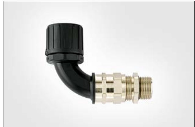
HelaGuard HG-90CG 90°-Verschraubung mit Zugentlastung und Kabelabdichtung, Außengewinde, IP66.
