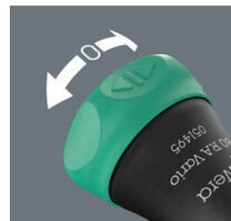
Intuitives Umschalten der Ratschenmechanik. Wird der Drehschalter nach rechts geschaltet, ist die Schraubrichtung rechts; wird er nach links geschaltet, ist die Schraubrichtung links. Mit der 0-Position kann die Ratschenmechanik für präzise Arbeiten deaktiviert werden.
