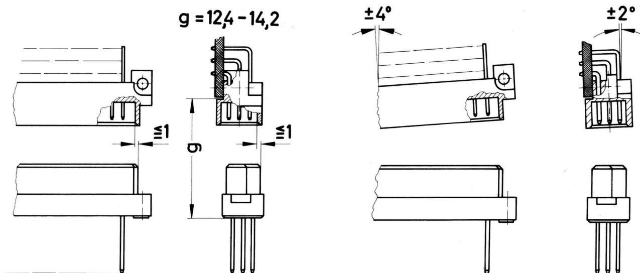
Um eine sichere Kontaktgabe zu gewährleisten und ein Beschädigen der Steckverbinder zu verhindern, sind nachfolgende Einbauhinweise zu beachten.
