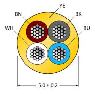
5 ± 0.20mm Leitungsdurchmesser Leitungslänge 5 m Leitungsmaterial PVC Leitungsfarbe Gelb Aderisolierung PVC Aderfarben
