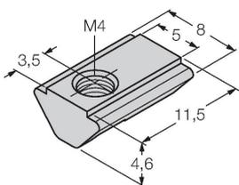
Nutstein mit M4-Gewinde für rückseitiges Sensorprofil beim Linearwegsensor LI-Q25L; Material: St verzinkt; 10 Stück pro Beutel
