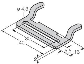
Montageklammer für Linearwegsensor Q25L; Material: Edelstahl; 2 Stück pro Beutel
