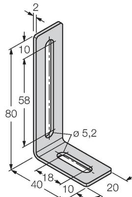
Montagewinkel und Nutstein für Linearwegsensoren LI-Q25L; Material: Edelstahl; 2 Stück pro Beutel
