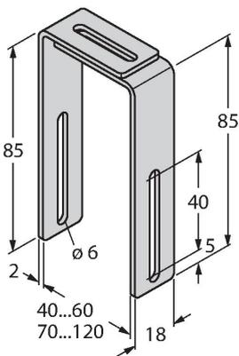
Montagewinkel für Linearwegsensoren Q25L, zur Montage auf Pneumatikzylindern (70...120 mm); Material: Edelstahl; 4 Stück pro Beutel
