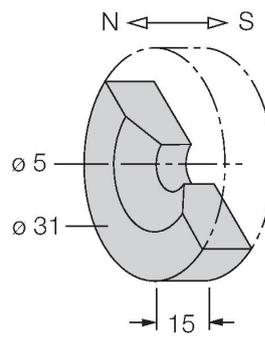
Betätigungsmagnet, Ø 31 mm (Ø 5 mm), h: 15 mm; erreichbarer Schaltabstand 90 mm auf Magnetfeldsensoren BIM-(E)M12 bzw. 78 mm auf BIM-EG08; bei Linearwegsensoren Q25L: empfohlene Entfernung zwischen Sensor und Magnet: 3...5 mm
