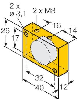
Betätigungsmagnet; Quader Kunststoff; erreichbarer Schaltabstand 58 mm auf Magnetfeldsensoren BIM-(E)M12 bzw. 49 mm auf BIM-EG08; bei Linearwegsensoren Q25L: empfohlene Entfernung zwischen Sensor und Magnet: 3...5 mm
