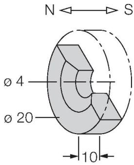
Betätigungsmagnet; Ø 20 mm (Ø 4 mm), h: 10 mm; erreichbarer Schaltabstand 59 mm auf Magnetfeldsensoren BIM-(E)M12 bzw. 50 mm auf BIM-EG08; bei Linearwegsensoren Q25L: empfohlene Entfernung zwischen Sensor und Magnet: 3...4 mm
