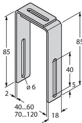
Montagewinkel für Linearwegsensoren Q25L zur Montage auf Pneumatikzylindern (40...60 mm); Material: Edelstahl; 4 Stück pro Beutel
