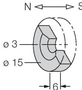
Betätigungsmagnet, Ø 15 mm (Ø 3 mm), h: 6 mm; erreichbarer Schaltabstand 36 mm auf Magnetfeldsensoren BIM-(E)M12 bzw. 32 mm auf BIM-EG08; bei Linearwegsensoren mit Q25L: empfohlene Entfernung zwischen Sensor und Magnet: 3...4 mm
