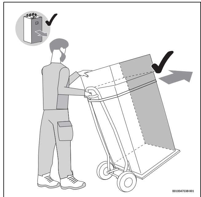
Bild 9 Inneneinheit mit einer Sackkarre transportieren
